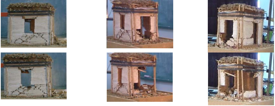
Şekil 7. HSS1 numunesinin hasar ve göçme sırası
