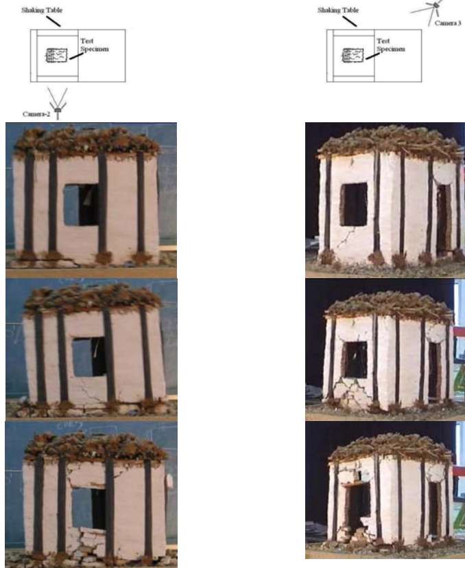
Şekil 9. VSS numunesinin hasar ve göçme sırası
