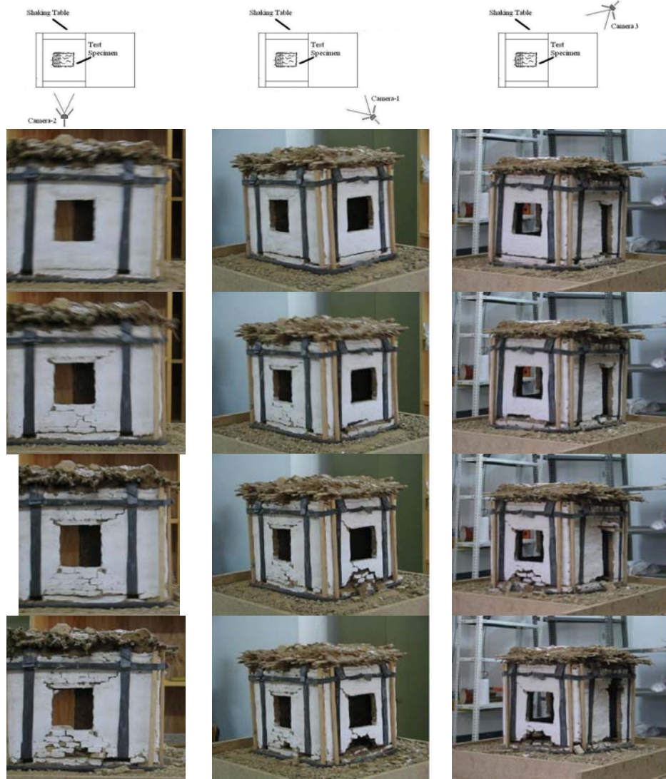
Şekil 10. VHSS1 numunesinin hasar ve göçme sırası
