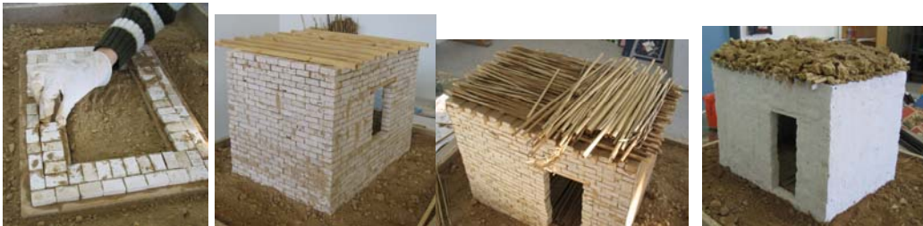
Şekil 2. Numunelerin yapım aşamaları
