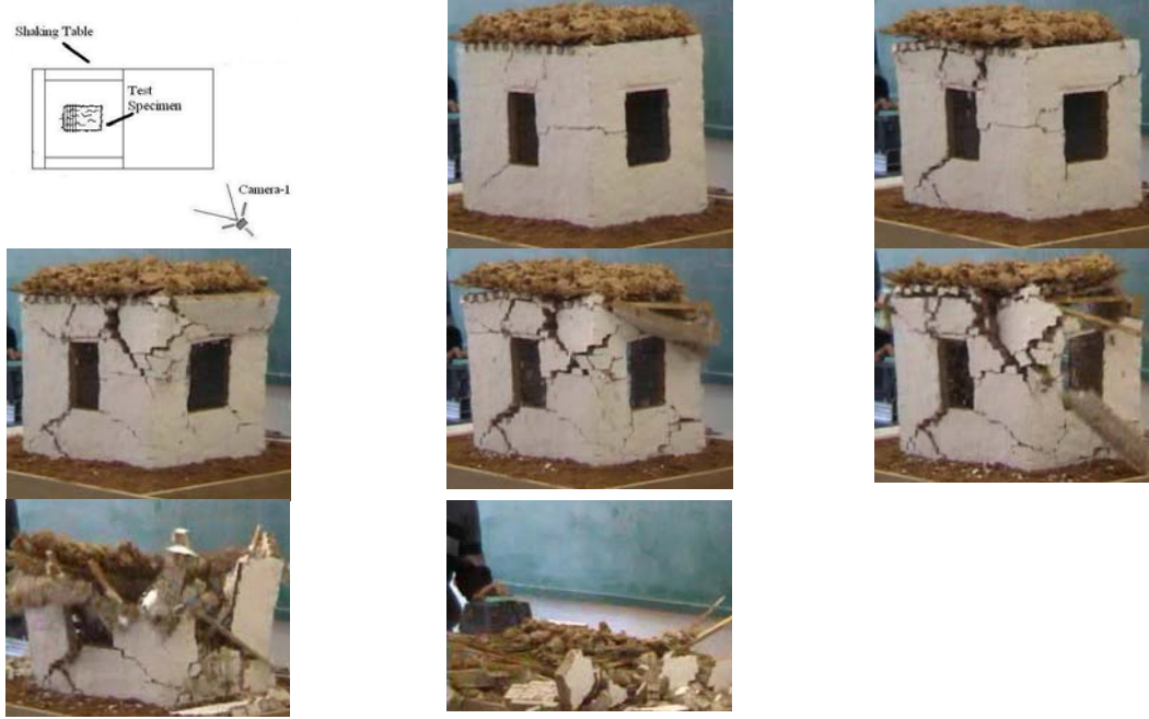
Şekil 4. RFO1 numunesinin hasar ve göçme sırası
