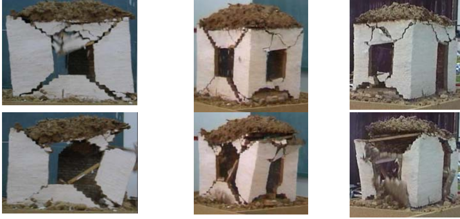
Şekil 5. RFO2 numunesinin hasar ve göçme sırası
