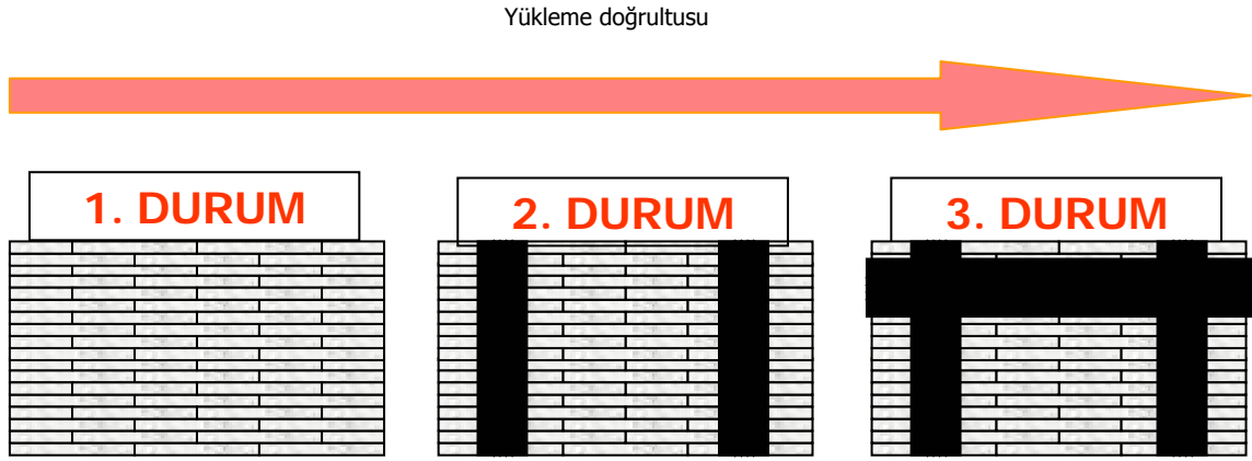
Şekil 2. Düzlem dışı yüklem alternatifleri ve yüklem doğrultusu
