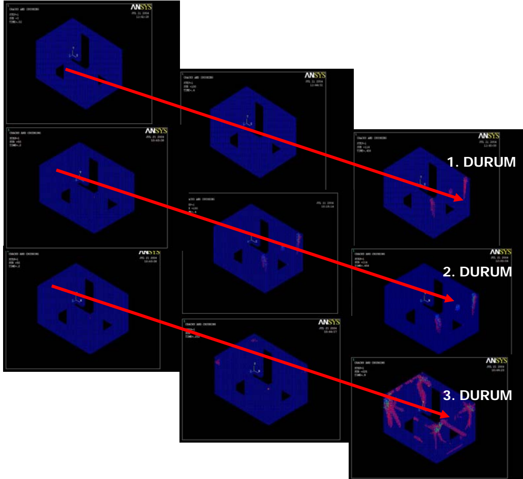
Şekil 6. Birebir ölçekli ev modeli için elde edilen çatlak oluşumları ( en soldaki şekiller maksimum yüklemdeki çatlakları yansıtmaktadır )
