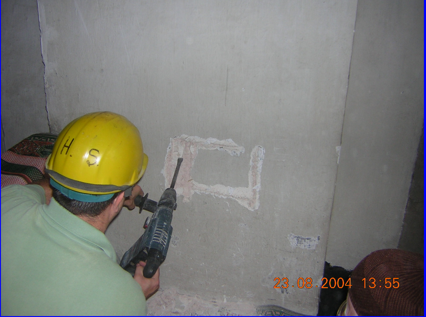
Şekil 2. Ölçüm yapılacak bölgelerin deneye hazırlanması, gerektiğinde kaplamanın kaldırılması
